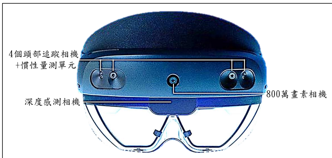
圖 20 HoloLens 2 之 MEMS 顯示部的正面透視圖 66
